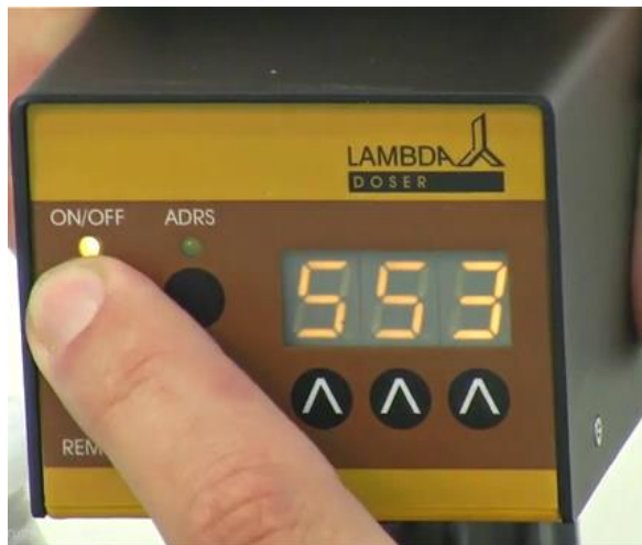
Obrázek 1-14: Potvrzení zvolené rychlosti dávkování stiskem tlačítka ON/OFF .
