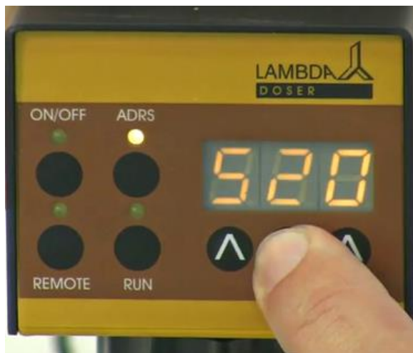
Obrázek 2-8: Vložte požadovanou hodnotu průtoku pro druhý krok programu.
