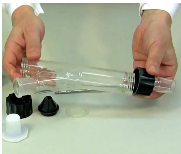
Obrázek 1-3: Šroubovací uzávěr spolu s teflonovou podložkou a skleněným adaptérem přišroubojeme na spodní část skleněné dávkovací nádoby s jedním bočním ramenem.
