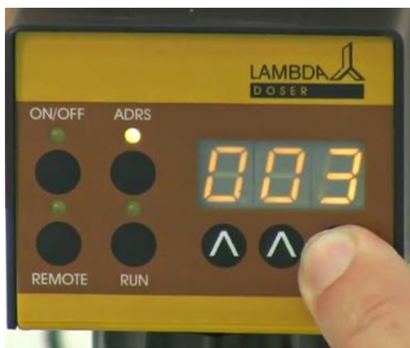
Obrázek 2-6: Nastavte požadovaný časový úsek pro první krok programu pomocí tlačítek ▲▲ pod displejem (v rozlišení: 0–999 min. nebo 00.0–99.9 min.). Tlačítkem ADRS se přepíná rozlišení času na celé minuty nebo na desetiny minuty (0,1 min. = 6 sec). Při rozlišení 0,1 minuty displej zobrazuje tečku, např. " 00.1 ". Rozlišení času může být nastaveno jednotlivě pro každý krok programu.
