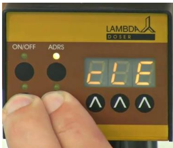
Obrázek 2-2: Pokud po zobrazení údaje "PGM" stále máme stisknutá tlačítka REMOTE a RUN zobrazí se následně na displeji písmena "cLE" .
