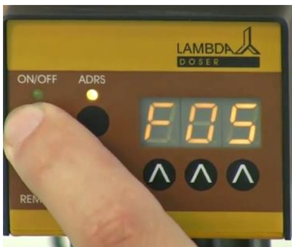
Obrázek 2-11: Po zadání hodnoty časového úseku posledního kroku znovu zmáčkněte tlačítko ON/OFF . Na displeji se opět objeví průtok 000 následujícího kroku, který však už nebude programován.
