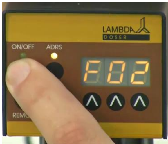
Obrázek 2-7: Stiskněte tlačítko ON/OFF . Na displeji se krátce zobrazí označení "F02" a lze začít s nastavením druhého kroku programu.
