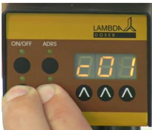
Obrázek 2-13: Současně stiskněte tlačítka REMOTE a RUN , na displeji se zobrazí "c01" . To znamená, že se program zopakuje jen jednou a přístroj se zastaví.
