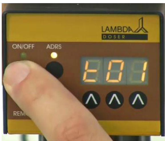
Obrázek 2-5: Pro potvrzení stiskněte tlačítko ON/OFF . Na displeji se objeví na několik sekund označení " t01 " ( t ime = čas) a nyní lze naprogramovat dobu v minutách pro průtok prvního kroku programu.
