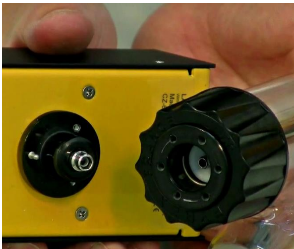
Obrázek 1-9: Osu pohonné jednotky vsuneme do hlavy dávkovače tak, aby jističí kolík zapadl do jednoho z otvorů na obvodě hlavy dávkovače.
