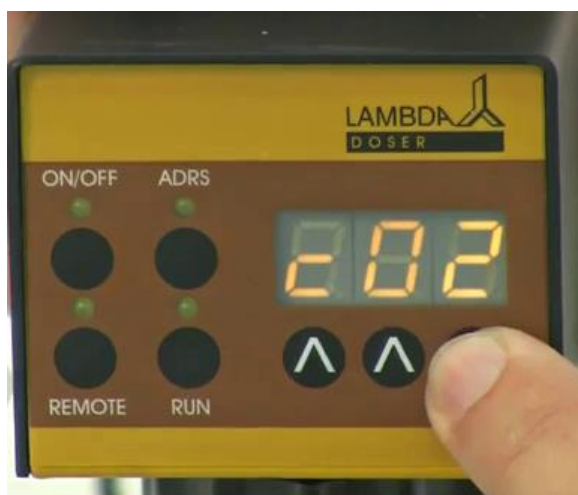
Obrázek 2-14: Pokud chcete program zopakovat dvakrát, nastavte "c02" stiskem tlačítka pod displejem ^ ^ ^ (0 až 99 cyklů). Program může být zopakován až 99x "c99" . Pokud je pro počet cyklů zadána nula "c00" , program bude opakován neustále, dokud nebude ručně ukončen (nekonečná smyčka).
