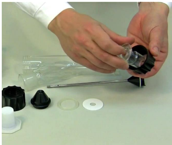
Obrázek 1-1: Skleněný adaptér se zábrusem NS 29/32 prostrčíme šroubovacím uzávěrem se závitem SVL 42.
