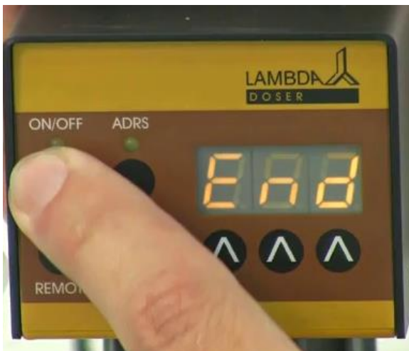
Abb. 29: Betätigen Sie die ON/OFF Taste bis “End” auf dem Display erscheint. Das ist die Bestätigung, dass das Programm gespeichert worden ist.
