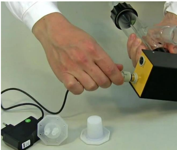
Abb. 11: Das Stecker-Netzteil mit 12 VDC Ausgangsspannung wird in die entsprechende 12V Buchse der Steuereinheit eingeschraubt und das Netzteil an die Netzspannung angeschlossen. Beim Anschluss ans Netz ertönt ein akustisches Signal und die Zahlen auf dem Display leuchten auf.
