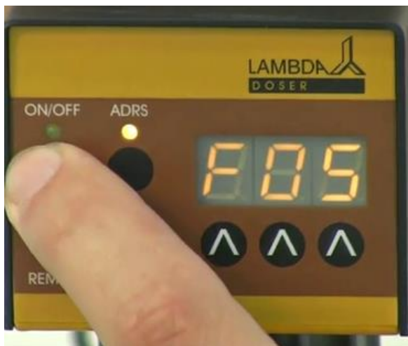
Abb. 25: Nachdem der Wert für die Zeit des letzten Schrittes eingegeben worden ist, wird die ON/OFF Taste gedrückt. Der Durchsatz (000) für den nächsten Schrittes, der nicht mehr programmiert werden soll, erscheint auf der Anzeige; z.B. „F05“.
