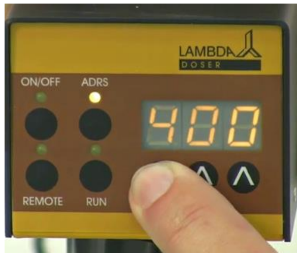
Abb. 18: Der Wert der Zugabegeschwindigkeit für den ersten Programmschritt wird über die drei Tasten ▲▲▲ unterhalb der Anzeige eingegeben. (Die Werte zwischen 000 und 999 entsprechen 0 bis 100% der maximalen Rotorgeschwindigkeit.)
