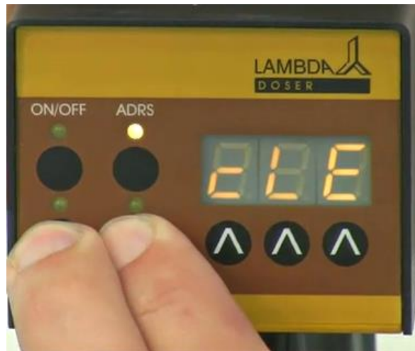
Abb. 16: Kontinuierliches gleichzeitiges Drücken der REMOTE und der RUN Tasten (nachdem „PGM“ bereits auf der Anzeige erschienen ist) führt zur Anzeige „cLE“: Das zuletzt gespeicherte Programm wurde gelöscht
