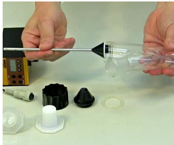
Abb. 4: Der Verteiler (Standard) wird mit seiner Öffnung nach unten in den Glastubus eingefügt, so dass er nicht beschädigt wird.
