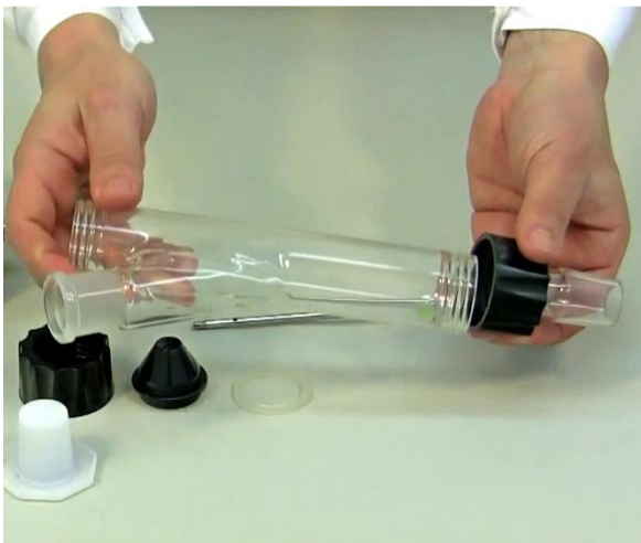
Abb. 3: Die Kappe wird mit dem Glastubus unten verschraubt.
