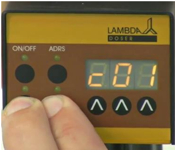
Abb. 27: Die REMOTE und RUN Tasten werden gleichzeitig gedrückt. Auf der Anzeige erscheint “c01” . Das heisst, dass das Programm nur einmal durchgeführt wird. Danach stoppt der DOSER bzw. Hi-DOSER Pulverdosierer.
