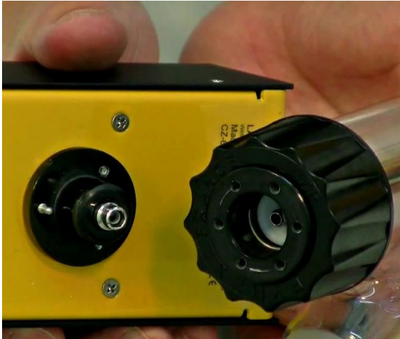
Abb. 9: Die Abbildung zeigt die Motorenachse mit Metallstift (ganz links) und das Zentrierteil mit seinen sechs Löchern.
