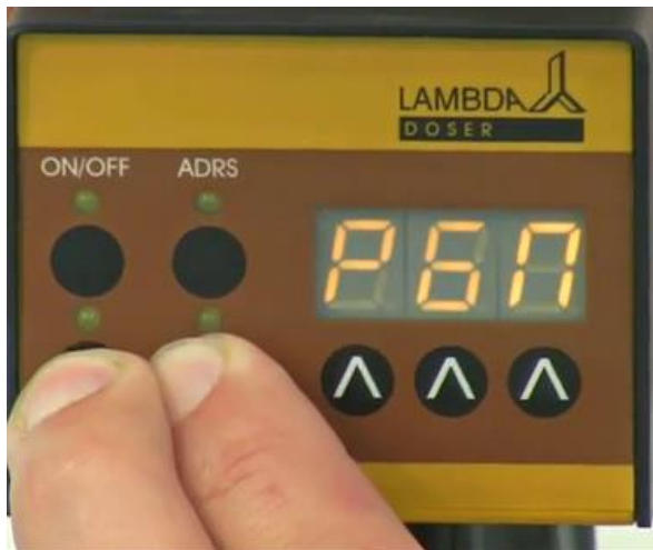
Abb. 15: Gleichzeitiges Drücken der REMOTE und RUN Tasten: „PGM“ erscheint auf der Anzeige.
