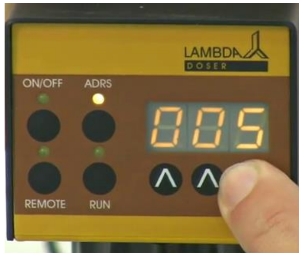
Abb. 24: Jetzt kann die Dauer für den zweiten Programmschritt über die drei Tasten ▲▲▲ eingegeben werden. Die Zeitauflösung (1 oder 0.1 Minute) kann wie oben beschrieben durch die ADRS -Taste erneute geändert werden.
