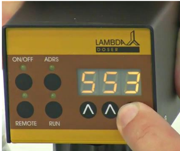
Abb. 13: Die Pulver-Zugabegeschwindigkeit wird mit Hilfe der drei Digital-Stellknöpfe \wedge \wedge \wedge eingestellt.
