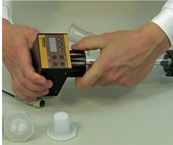
Abb. 10: Die Motoreinheit wird durch Druck und einer leichten Drehung bis zum Einrasten des Stifts mit der Verteilerachse gekoppelt. Das gewährt die perfekte Abdichtung des LAMBDA DOSER bzw. LAMBDA Hi-DOSER Pulverdosierers und den optimalen Druck des Verteilers gegen die Teflonscheibe am Boden des Glastubus.
