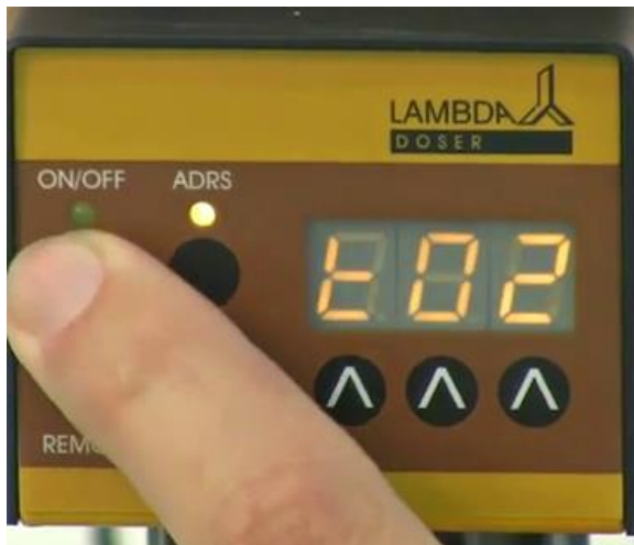
Abb. 23: Durch Drücken der ON/OFF -Taste wird der Wert gespeichert. „t02“ erscheint kurz auf der Anzeige.
