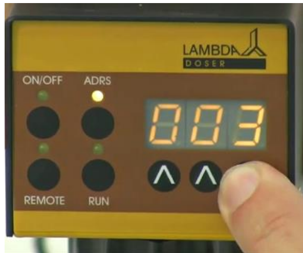
Abb. 20: Der Wert der Dauer des ersten Programmschrittes wird über die drei Tasten ▲▲▲ unterhalb der Anzeige eingegeben. (Die Werte entsprechen der Dauer von 0 bis 999 Minuten.)
