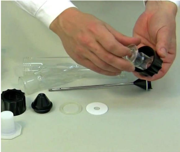
Abb. 1: Das Schliffteil wird durch die Schraubkappe geschoben.
