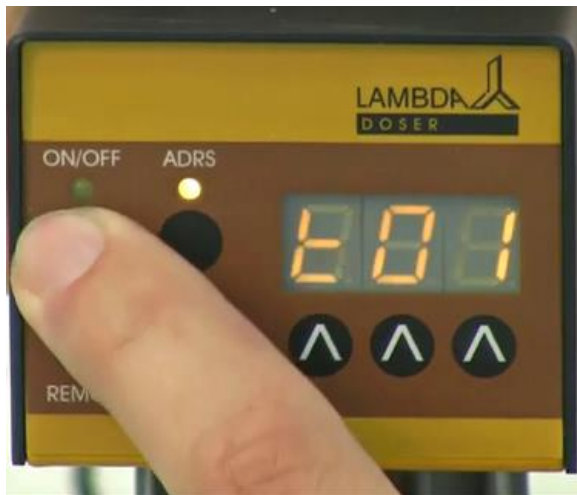
Abb. 19: Durch Betätigung der ON/OFF Taste wird der Wert gespeichert. „t01“ erscheint kurz auf der Anzeige. DOSER bzw. Hi-DOSER zeigt damit an, dass die Dauer (Minuten) des ersten Programmschrittes eingegeben werden kann.
