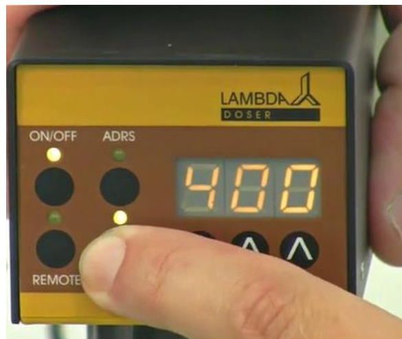
Abb. 30: Um das Programm zu STARTEN , wird die RUN Taste gedrückt.
