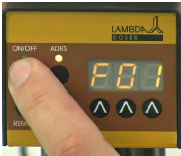
Abb. 17: Die ON/OFF Taste wird gedrückt. „F01“ erscheint kurz auf der Anzeige. Der DOSER bzw. Hi-DOSER zeigt damit an, dass die Zugaberate (Förderrate) des ersten Programmschrittes eingegeben werden kann.
