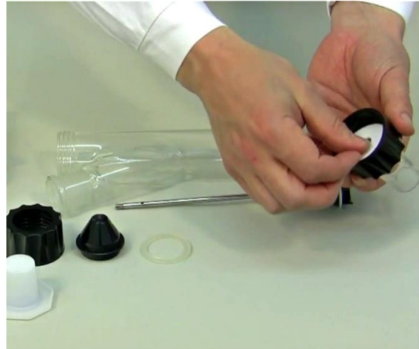
Abb. 2: Anschliessend wird die Teflonscheibe in die Schraubkappe und auf den Planschliff des Schliffteils gelegt.
