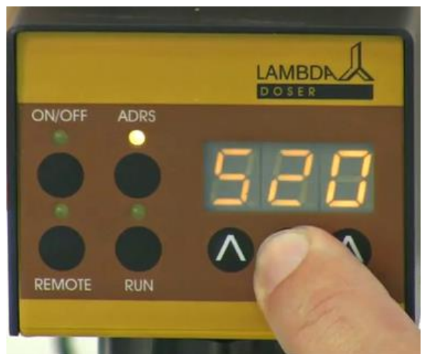
Abb. 22: Jetzt kann die Durchflussrate des zweiten Programmschrittes über die drei Tasten ▲▲▲ unterhalb der Anzeige eingegebene werden.
